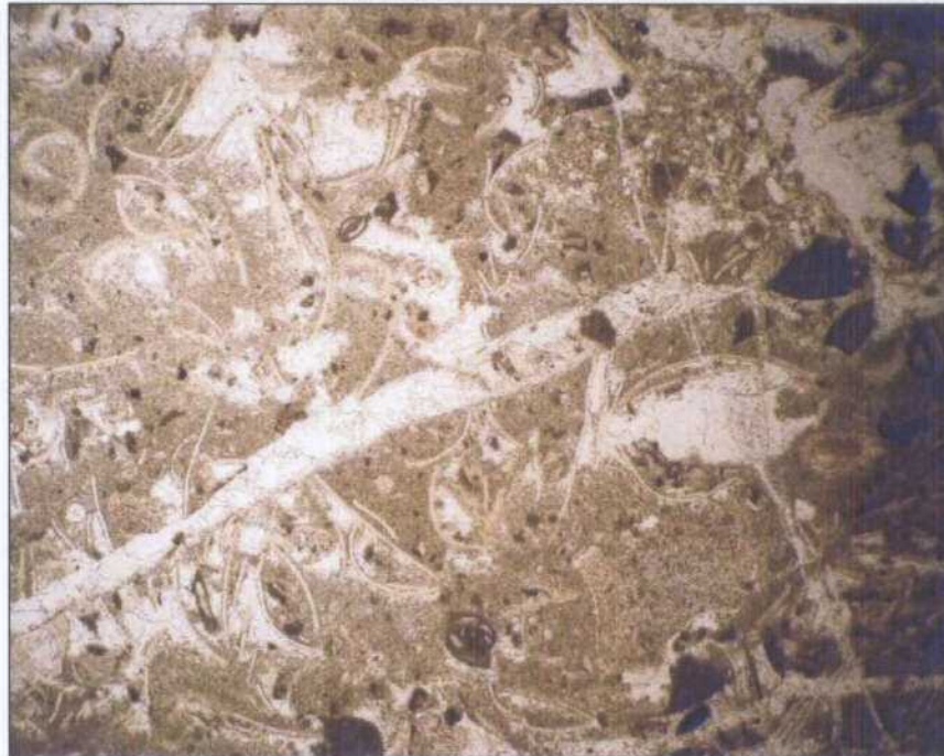
Foto 18. Fotografía de microscopio donde se observan los diferentes microfósiles encontrados en la Crinoidita de la Sierra del Almirante. Nícoles paralelos.
